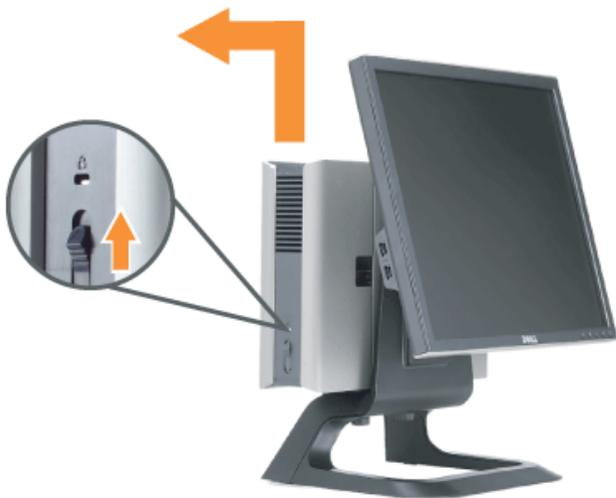
3. Appuyez sur le bouton d'ouverture sur le câble d'alimentation avant de le retirer de l'ordinateur.
