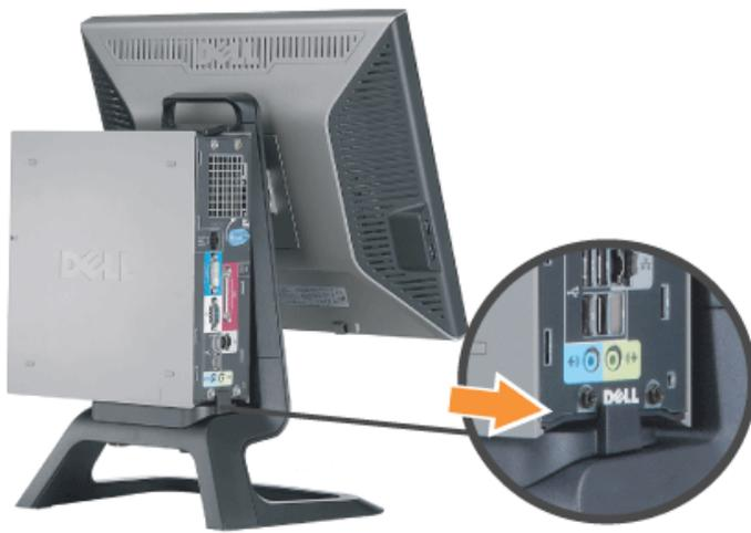
3. Serrez les vis papillon sous le socle.
