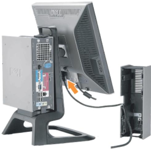
6. Faites passer le câble de l'adaptateur d'alimentation (livré avec l'ordinateur) à travers l'ouverture située au bas du Cache de Câble et connectez-le à l'ordinateur. Poussez-le jusqu'à ce qu'il soit verrouillé.
