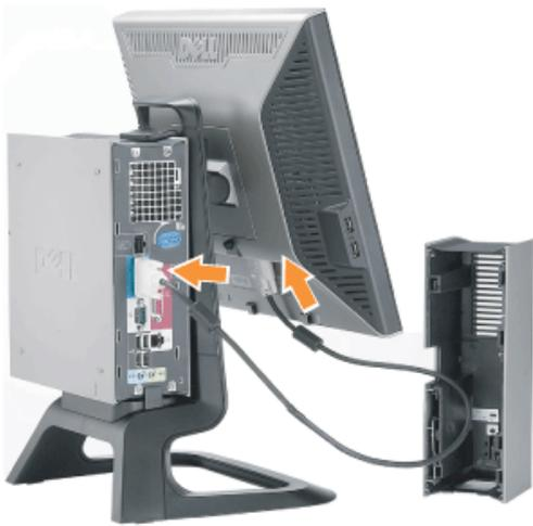
5. Faites passer le câble d'alimentation à travers les ouvertures situées à la base du Cache des Câbles et connectez-le au réceptacle du cordon d'alimentation au dos du moniteur.
